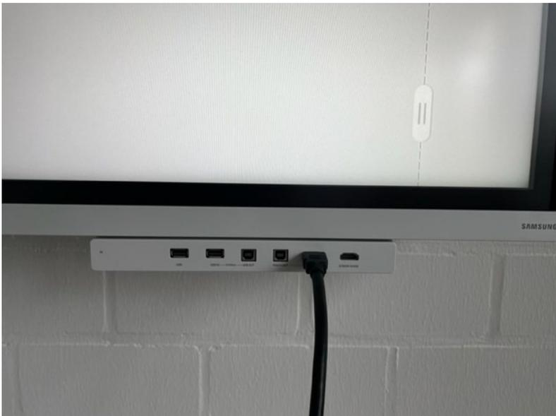
Um auf dem Display zum Beispiel eine Präsentation zu zeigen muss das HDMI-Kabel in den linken HDMI-Anschluss gesteckt werden.
